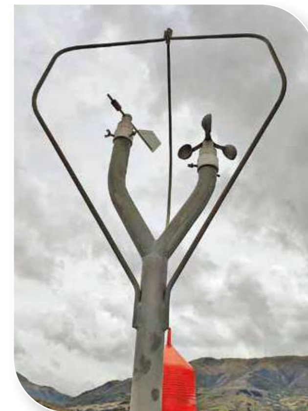
Sensores de control para los aerogeneradores del Parque Eólico Qollpana
